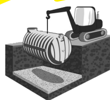
MISE EN FOUILLE ET DÉPOSE SUR LIT DE POSE AVEC LE MOYEN DE MANUTENTION APPROPRIÉ.
